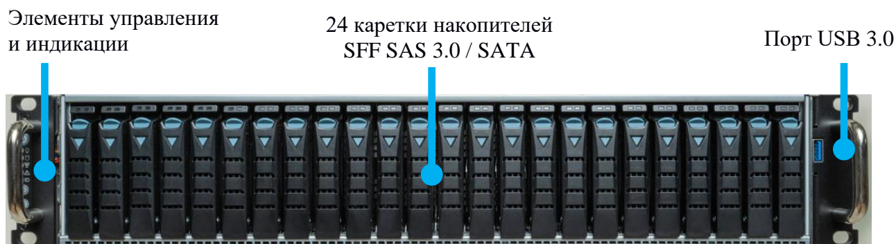
Рисунок 3 – Функциональные элементы, расположенные на передней панели корпуса изделия
