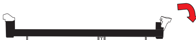
Рисунок 14 – Разблокировка гнезда DIMM
