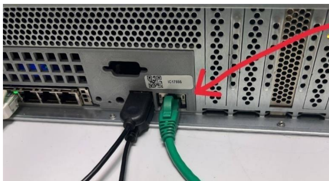
Рисунок 36 – Подключение кабеля RJ-45
