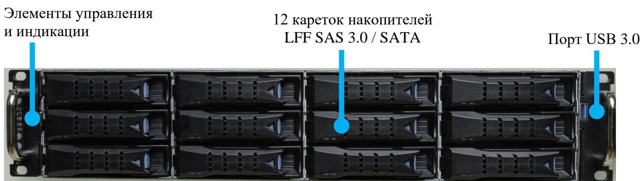
Рисунок 3 – Функциональные элементы, расположенные на передней панели корпуса изделия
