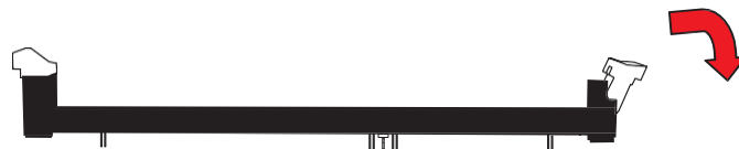
Рисунок 14 – Разблокировка гнезда DIMM
