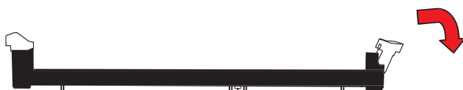
Рисунок 14 – Разблокировка гнезда DIMM
