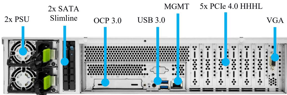
Рисунок 4 – Функциональные элементы, расположенные на задней панели корпуса изделия
